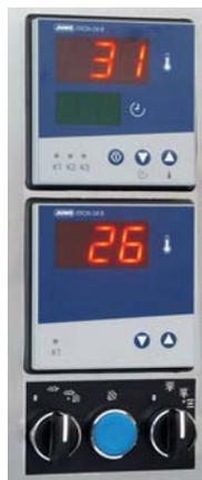
Chaque chambre de cuisson peut être gérée indépendamment, de même que l'appareil à buée. L'injection peut être gérée manuellement, sur le même principe que la buée pulsée.
